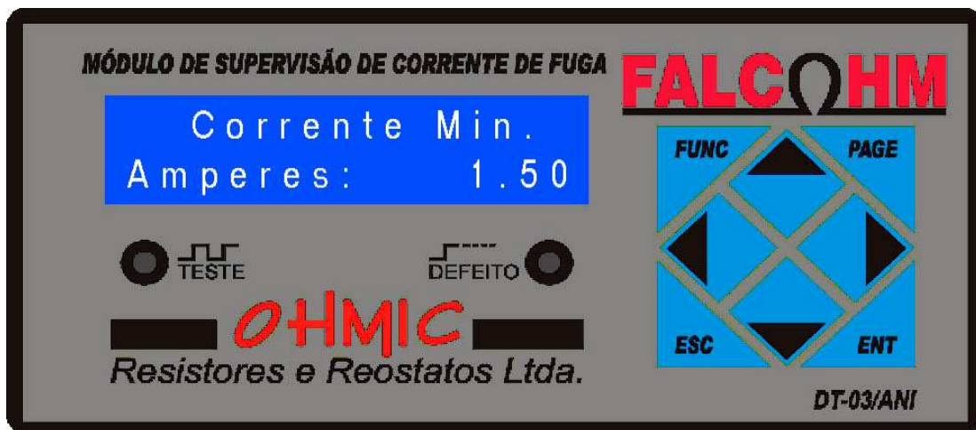
Figura 16 - Tela de Indicação do Limite para Alarme de Aterramento.
