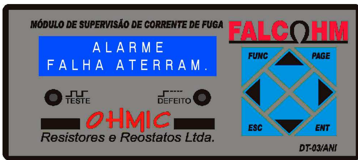
Figura 11 - Tela de Alarme de Aterramento.
