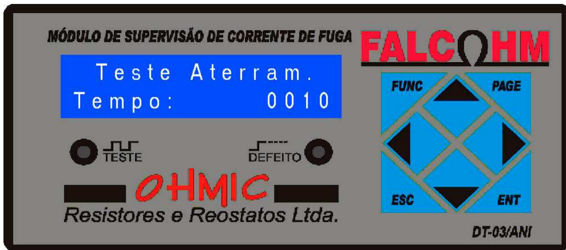
Figura 16a - Tela de Indicação do Tempo para Teste de Aterramento Automático.
